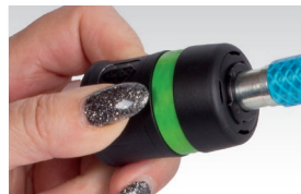
Bezpečnostné rýchlo spojky: jeden ťah dole a stlačený vzduch je uvoľnený. Jedno stlačenie hore a vsuvka je bezpečne odpojená
